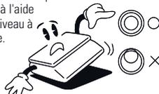
Éloignez la balance d'autres appareils électromagnétiques, cela pourrait interférer avec la précision des relevés.
